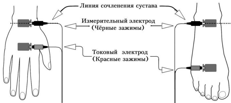
Рисунок 5. Схема крепления измерительных и токовых электродов на конечностях обследуемого [8].
